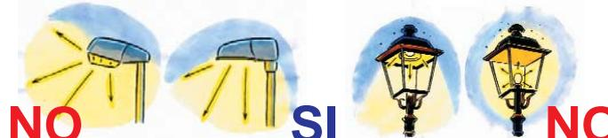
Usare lanterne con lampade recessate nel vano ottico, schermate e senza vetri di protezione (o vetro piano orizzontale)
