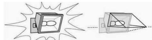
Se si inclina il fascio luminoso è necessario inserire uno schermo per impedire la dispersione di luce verso l'alto
