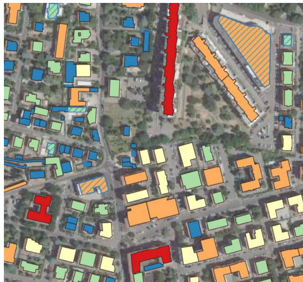
Fig.9 - Classificazione del potenziale FV su database catastale / DBTR
