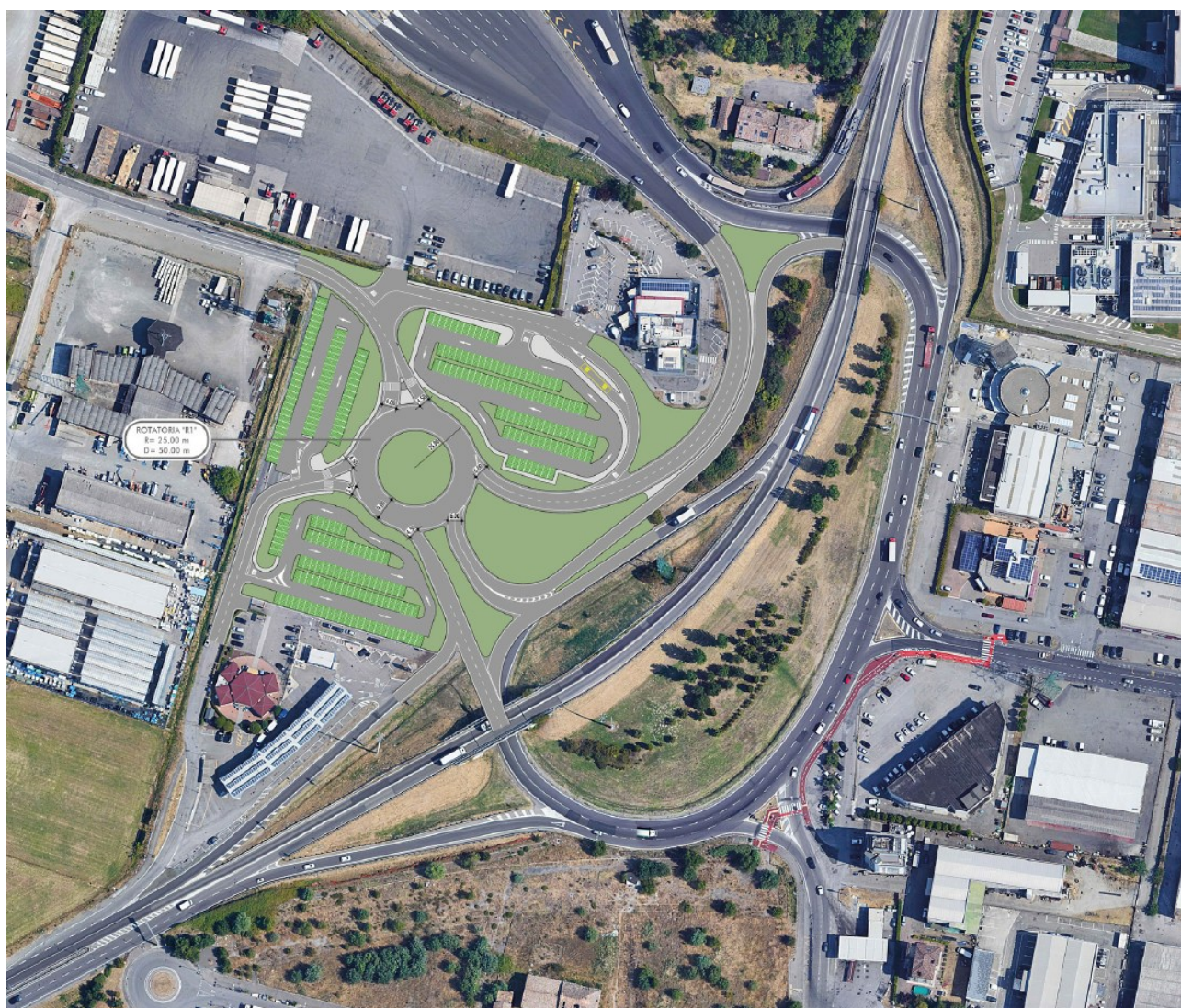
FIGURA 2-4 PROPOSTA PROGETTUALE 1 A NORMA – STRALCIO DELLA PLANIMETRIA DI PROGETTO
