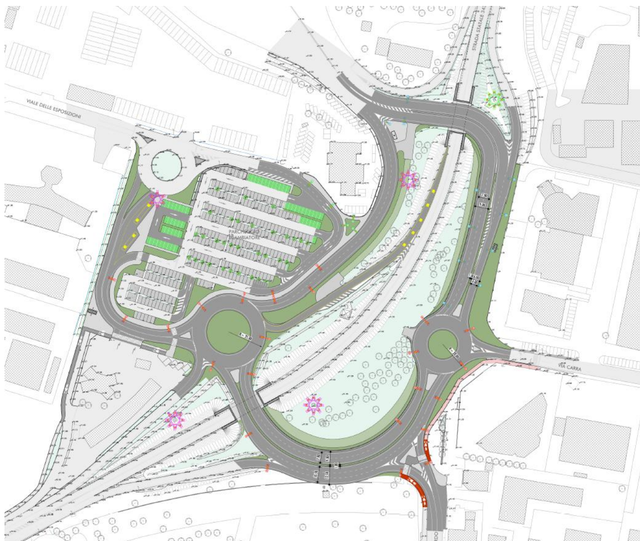
FIGURA 3-16 PLANIMETRIA DI PROGETTO DELL'IMPIANTO DI ILLUMINAZIONE (IMMAGINE RAPPRESENTATIVA)
