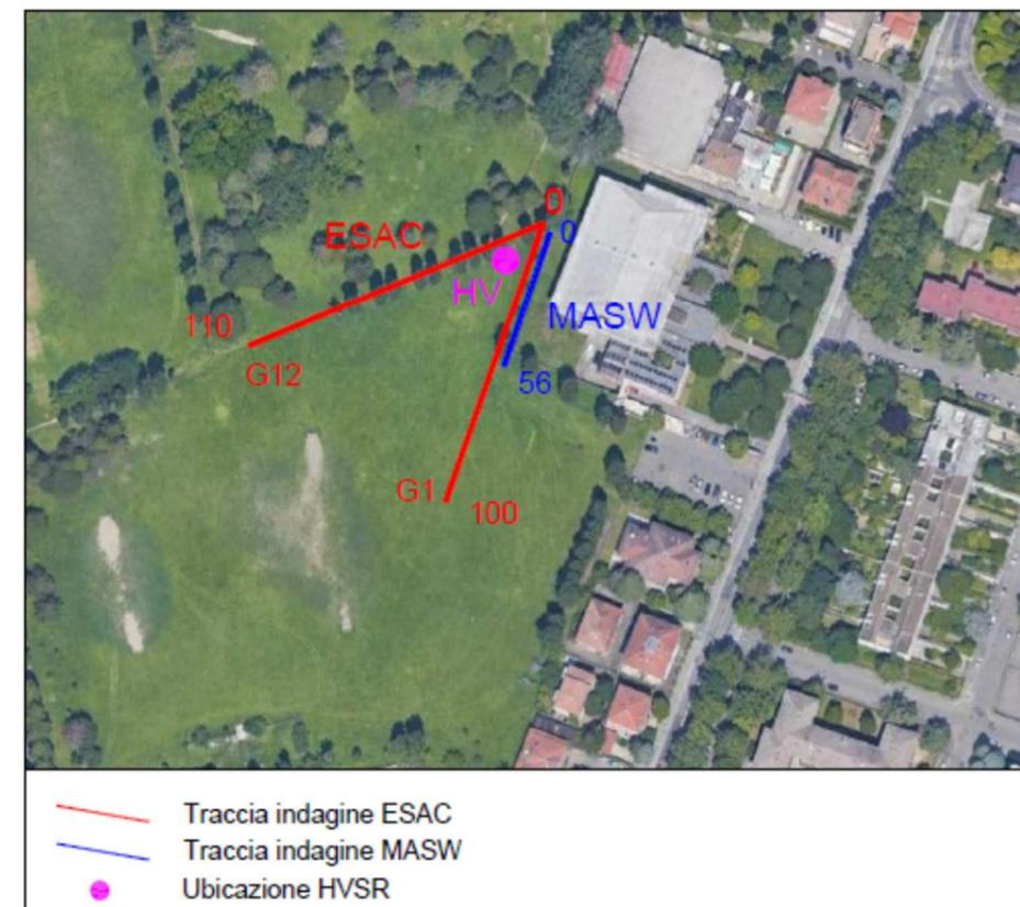
Figura 12: Ubicazioni delle indagini sismiche MASW
