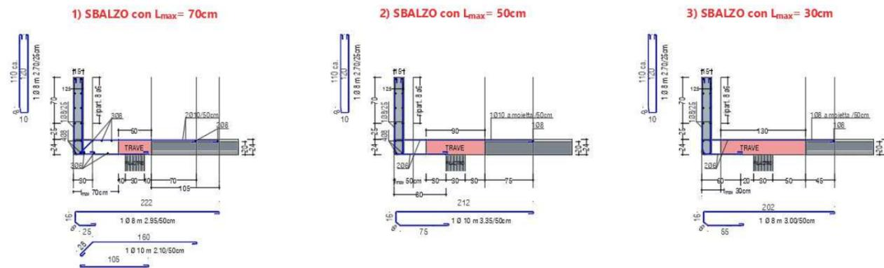
Figura 5: Tipologici degli sbalzi presenti a 2° solaio superiore
